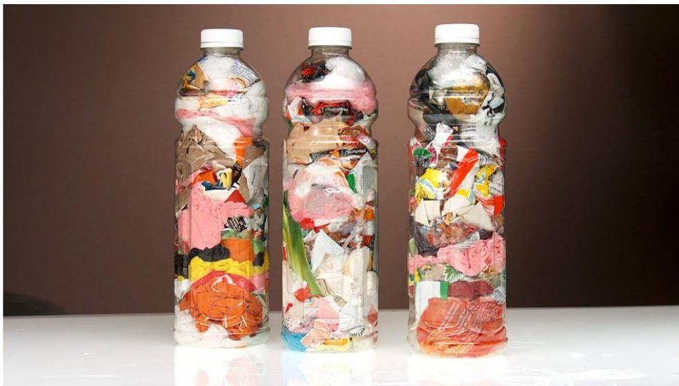
La idea es que la botella se llene de estos residuos hasta que quede todo su contenido a presión, para que la botella no pueda deformarse y así crear un "ladrillo ecológico" que puede ser utilizado en proyectos de construcción.
